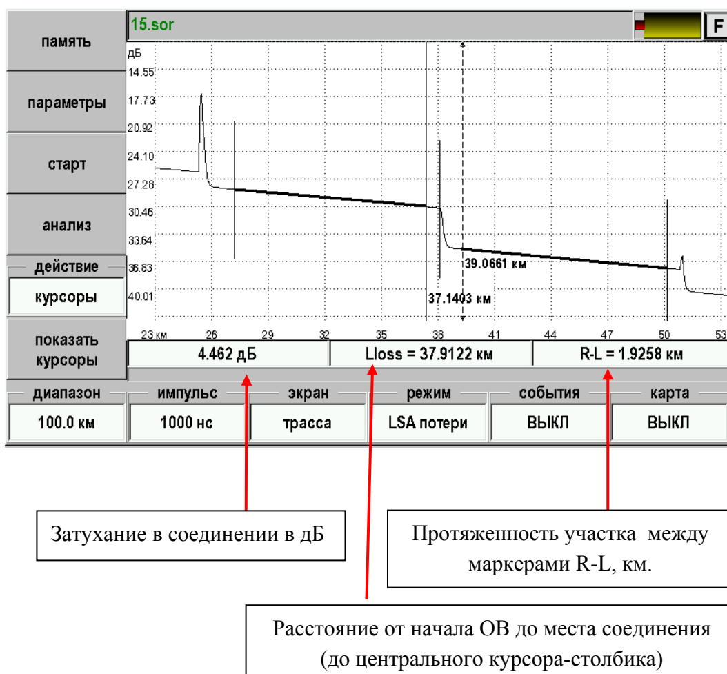
Рис. 35. Измерение затухания в соединении ОВ.
